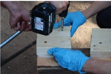
Probekörper für das Labor herstellen
